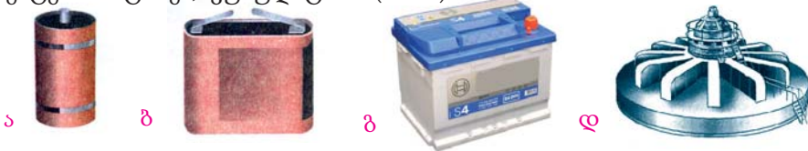
ნახ. 1. ელექტრული ენერჯის წყაროები: ა – გალვანური ელემენტი; ბ – გალვანური ელემენტების ბატარეა; გ – აკუმულატორი; დ – ელექტროგენერატორი
