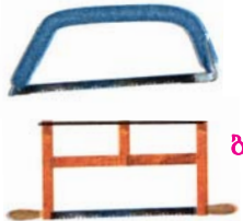
ნახ. 2. ხერხის სახეები: ა – ხერხუნა; ბ – სისო ხერხი; გ – ელექტრული დისკიანი ხერხი.
