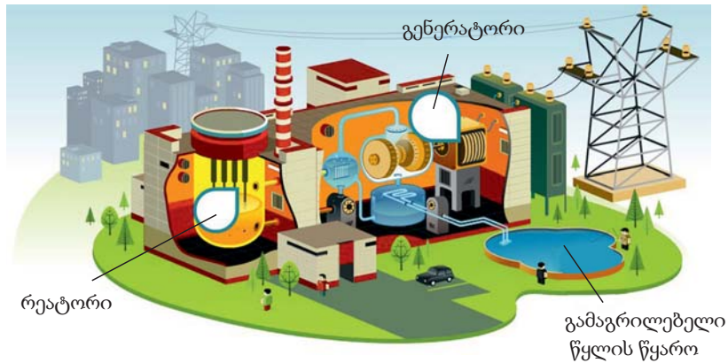
ნახ. 3. ელექტროენერჯის მიღება ატომურ ელექტროსადგურზე
