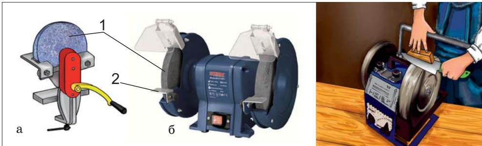
ნახ. 1. ა – ხელის სალესი მოწყობილობა; ბ – ელექტროსალესი დაზგა: 1 – სალესი ქვა, 2 – საყრდენი
