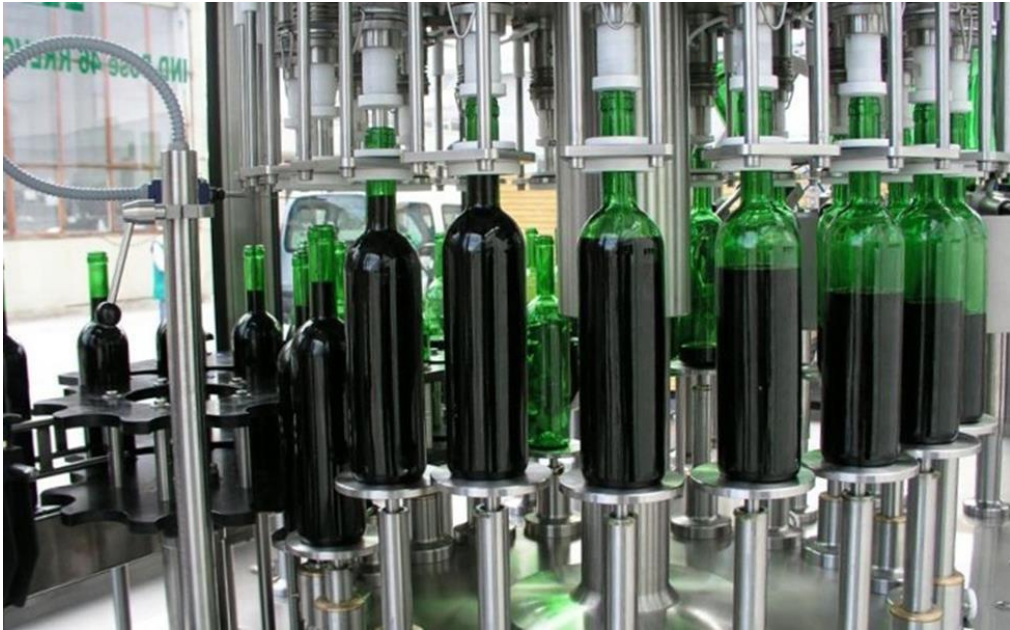
Şəkil 4.10. Hazır şərabın satış üçün butulkalara doldurulması prosesi
