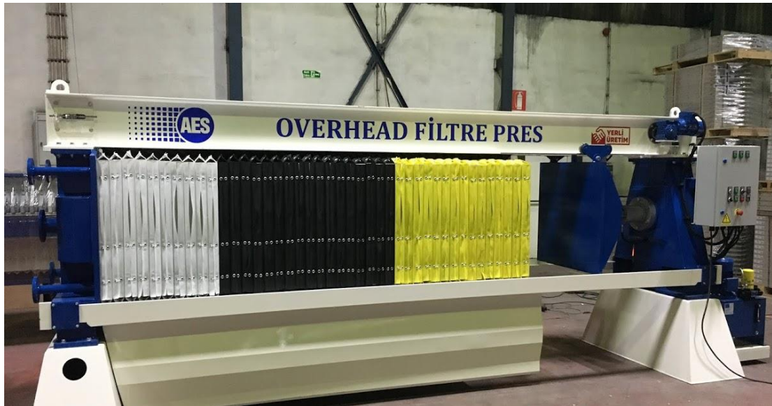
Şəkil 3.3. Müasir filtr-preslə böyük miqdarda şərabın avtomatik sürətli süzülməsi prosesi
