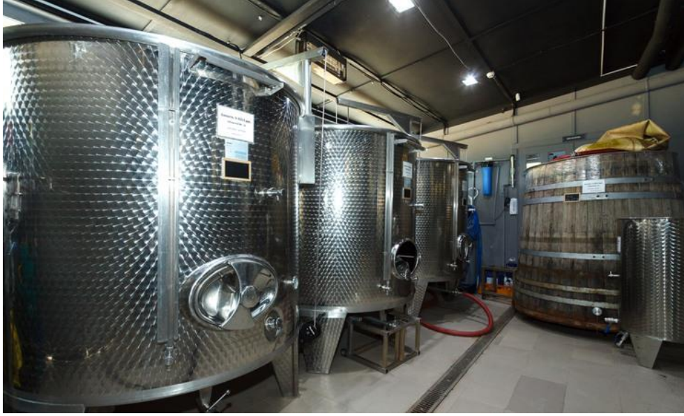
Şəkil 3.1. Müasir şarab köçürülmə çanları
