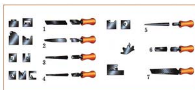
Рис. 1. Виды напильников по форме поперечного сечения и примеры их применения: 1 – плоский; 2 – полукруглый; 3 – квадратный; 4 – трехгранный; 5 – круглый; 6 – ромбический; 7 – ножовый
