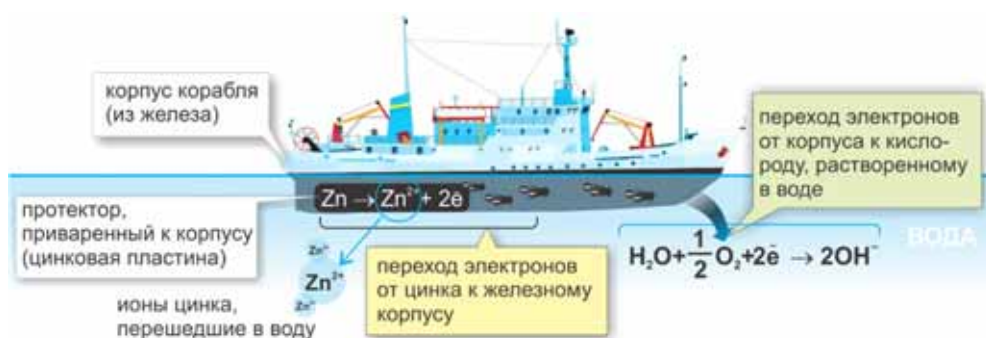
(d) Схема протекторной защиты корпуса корабля
