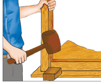
Şəkil 4. Bərkidilmələrin boşaldılması üçün taxta çəkicin tətbiqi
