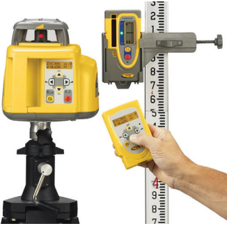
Nivelir – ərazidə relyef formalarının plana alınması üçün istifadə olunur
