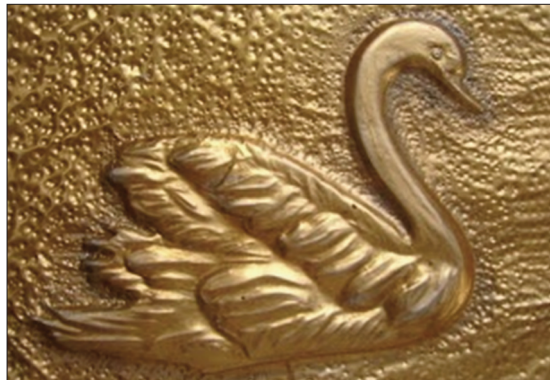
Şəkil 1. Zərbəmə üsulu ilə hazırlanmış dekorativ məmulatlar
