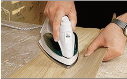
Şəkil 8. Ütü vasitəsilə şponun yapışdırılması
