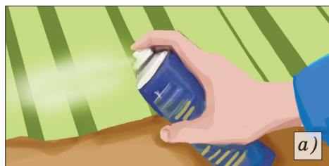
Şəkil 1. Metalın rənglənməsi və ya laklanması: a) tozlandırma üsulu ilə; b) fırça ilə
